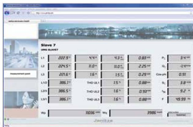
Abb.: Anzeige von Messwerten eines individuellen Slavegerätes
