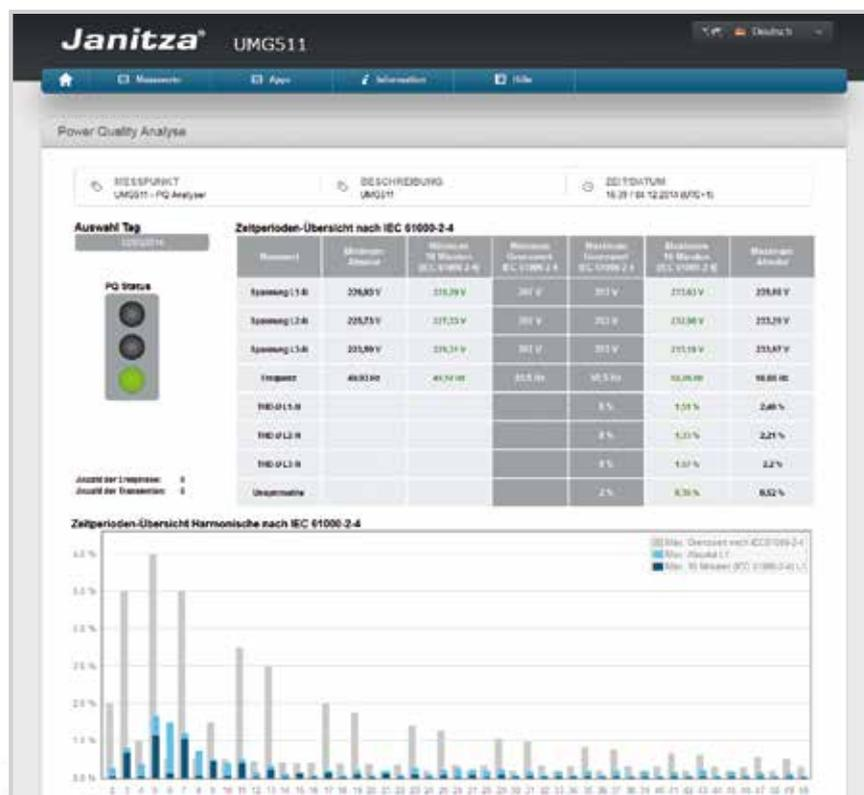
Abb.: APP Netzqualitätsüberwachung nach IEC 61000-2-4
