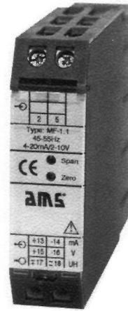
Die Messumformer MF-1.1 dienen zur Umformung und Trennung einer Frequenz in ein eingepprägtes Gleichstrom- und Gleichspannungssignal. Die zu messende Frequenz gelangt über einen internen Spannungswandler, der zur galvanischen Trennung dient, zu einem Filter und anschließend zu einem Mikrocontroller, der die Auswertung übernimmt. Die hier gewonnene Gleichspannung wird in einen eingepprägten Gleichstrom und eine eingepprägte Gleichspannung umgeformt.
