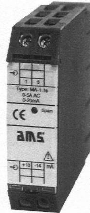
Die Messumformer MA-1.1s dienen zur Umformung eines sinusförmigen Wechselstroms in ein eingepprägtes Gleichstrom- und/oder Gleichspannungssignal. Der zu messende Wechselstrom gelangt über einen internen Stromwandler, der zur galvanischen Trennung dient, zur nachfolgenden Gleichrichterschaltung. Die gewonnene Gleichspannung wird verstärkt und in einen eingepprägten Gleichstrom oder eine eingepprägte Gleichspannung umgeformt. Der Ausgang ist leerlauf- und kurzschlussfest.
