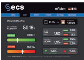
Kosten: Visualisierung des Monats- und Tagessaldos, der in Ihrer Währung angezeigt wird. Möglichkeit der Anzeige von erzeugter Energie.
